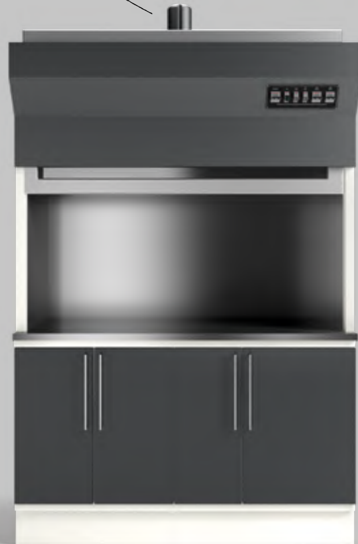
Hotte pour fours équipée d'aspiration 400m 3 /heure, filtre métallique ainsi que prédisposition pour filtre à charbons actifs (TK1 L=125cm, TK2 L=150cm). Complété par des meubles avec porte
